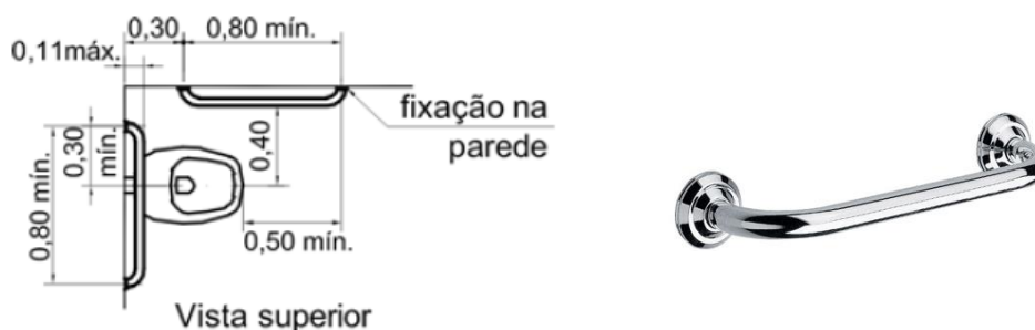
Figura 6 – Detalhamento das barras de apoio.
